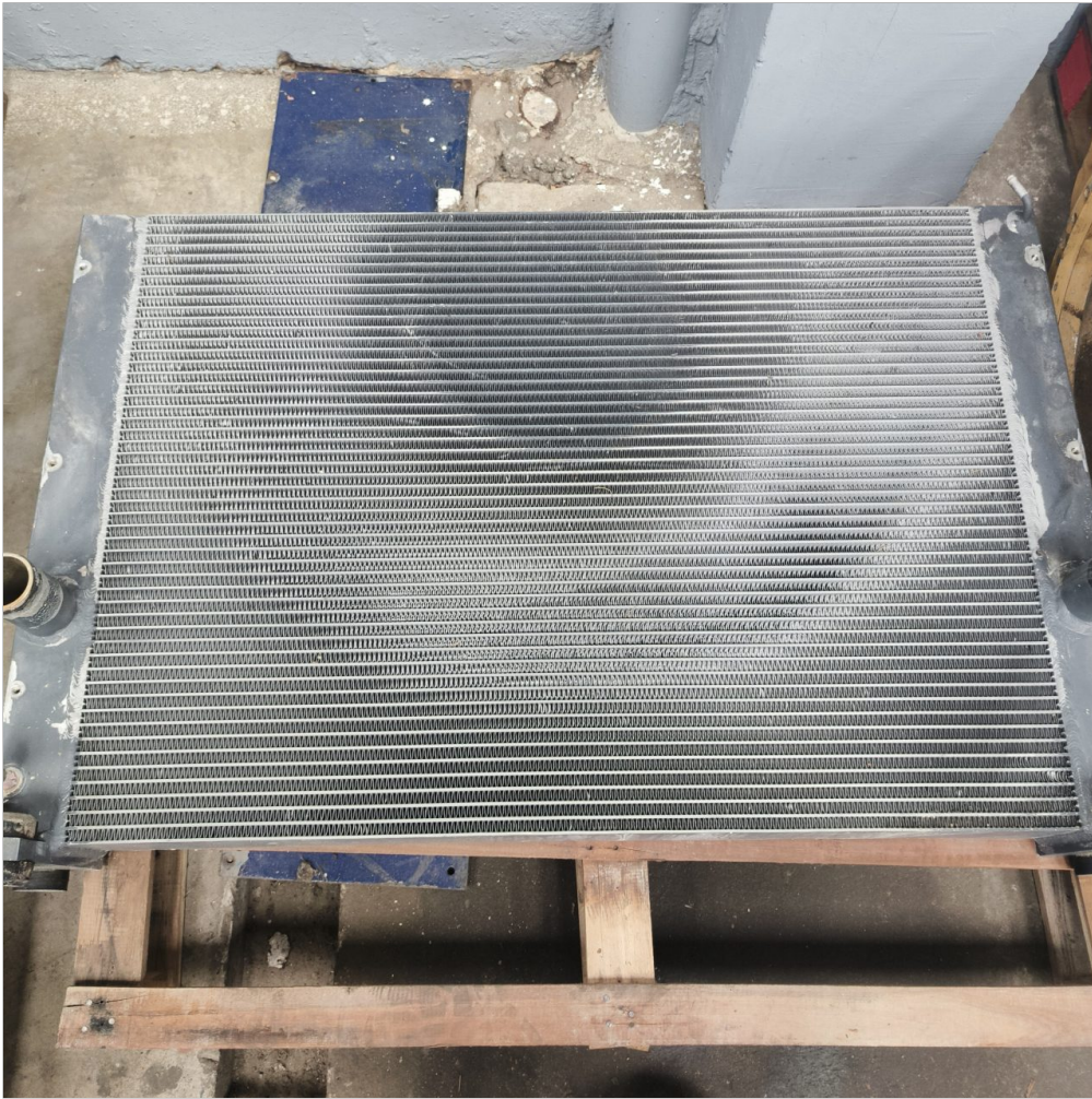
Radiador - Pos limpieza
