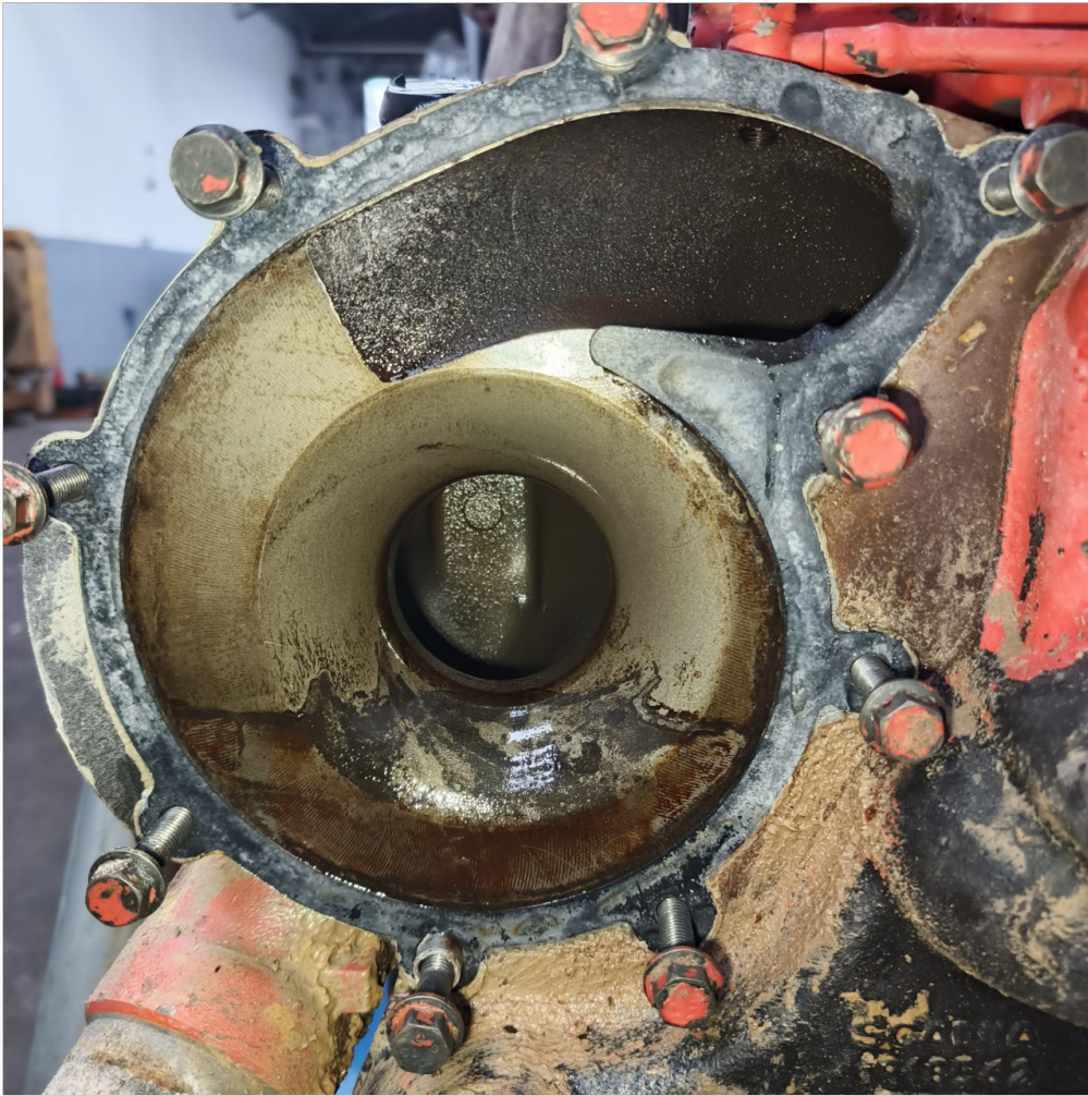
Bomba de agua - desmontaje 1
