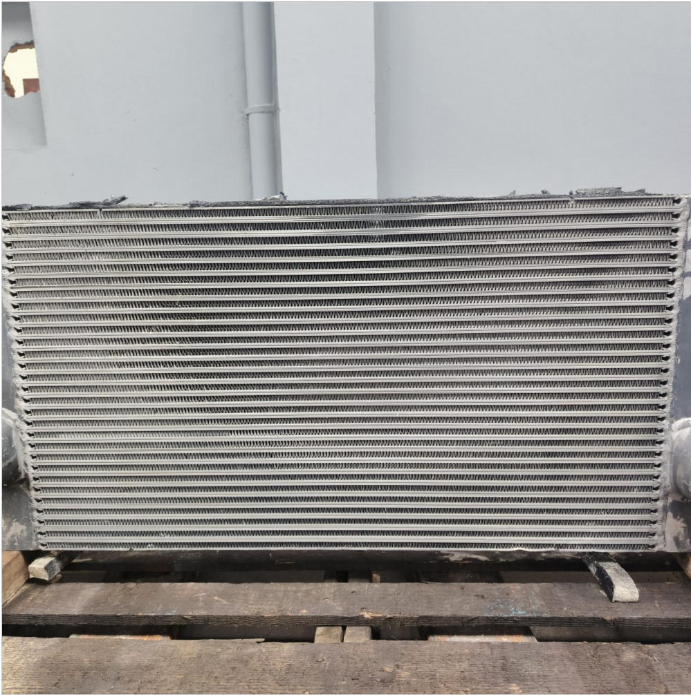
Radiador - intercooler pos limpieza
