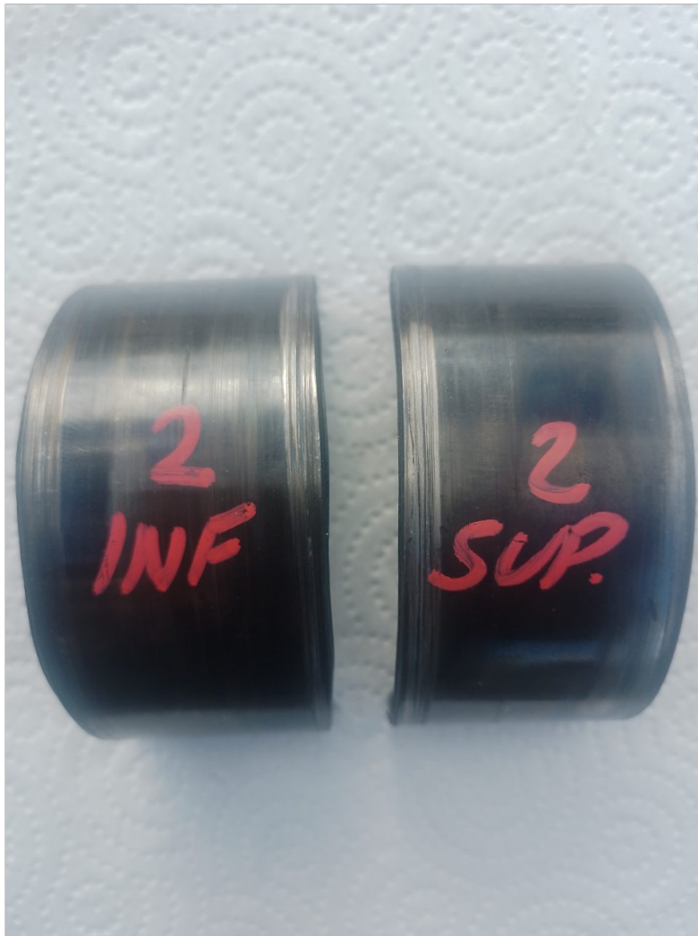
Exterior de cojinetes biela 2. Rayas en bordes por haberse girado dentro de la biela.
