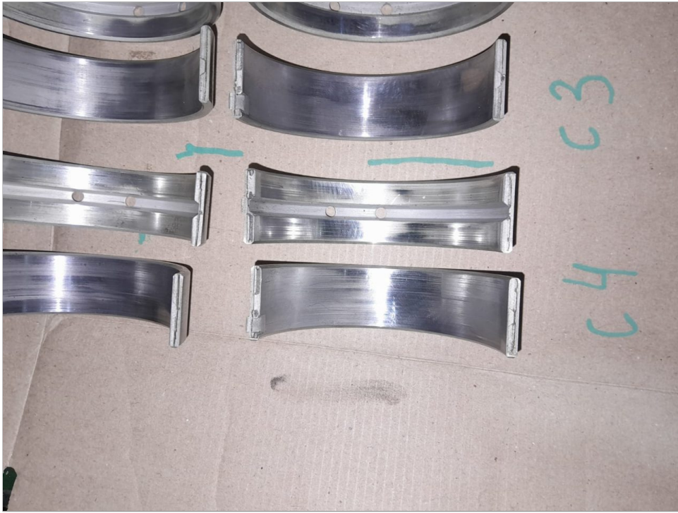
Interior del cojinete de bancada nro. 4
