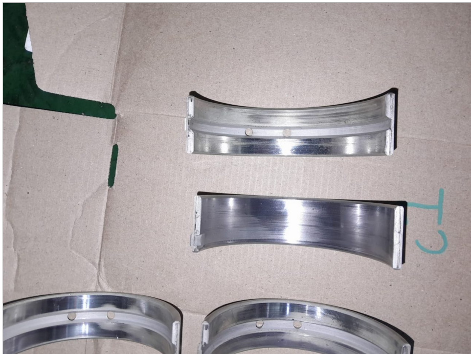
Interior del cojinete de bancada nro. 1
