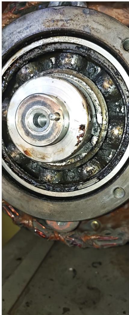
Ruleman en mal estado
