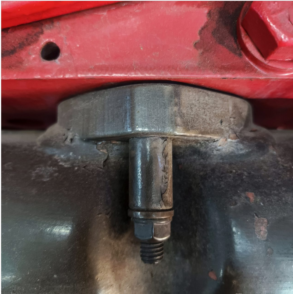
Deteccion de indicio de fuga gases de escape (foto 2)
