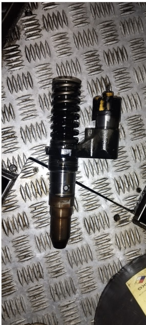
Inyector N°3 reemplazado
