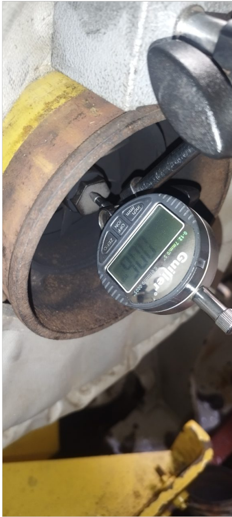
Cheque de huelgo axial de turbo compresores
