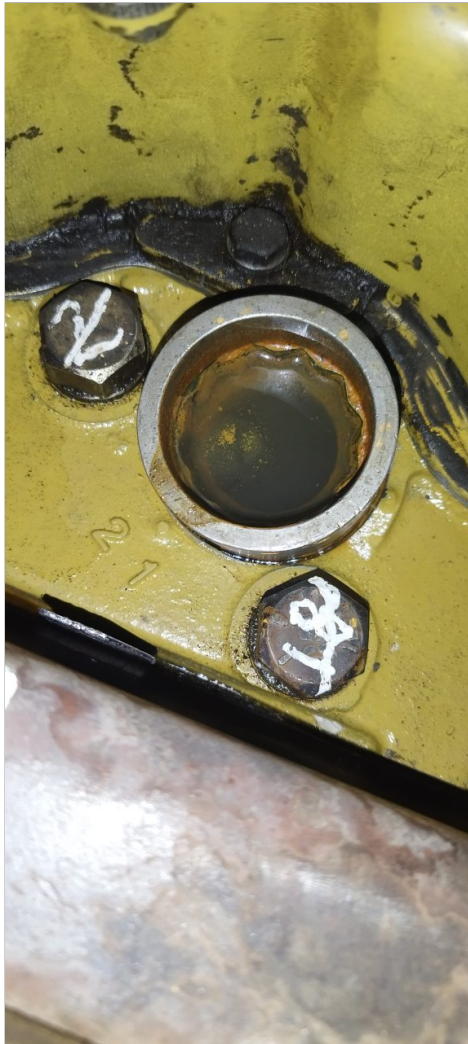
Presencia de agua en cilindros
