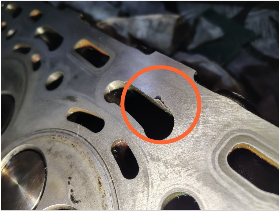
Daños generados probablemente por la rotura de una varilla del cilindro 2
