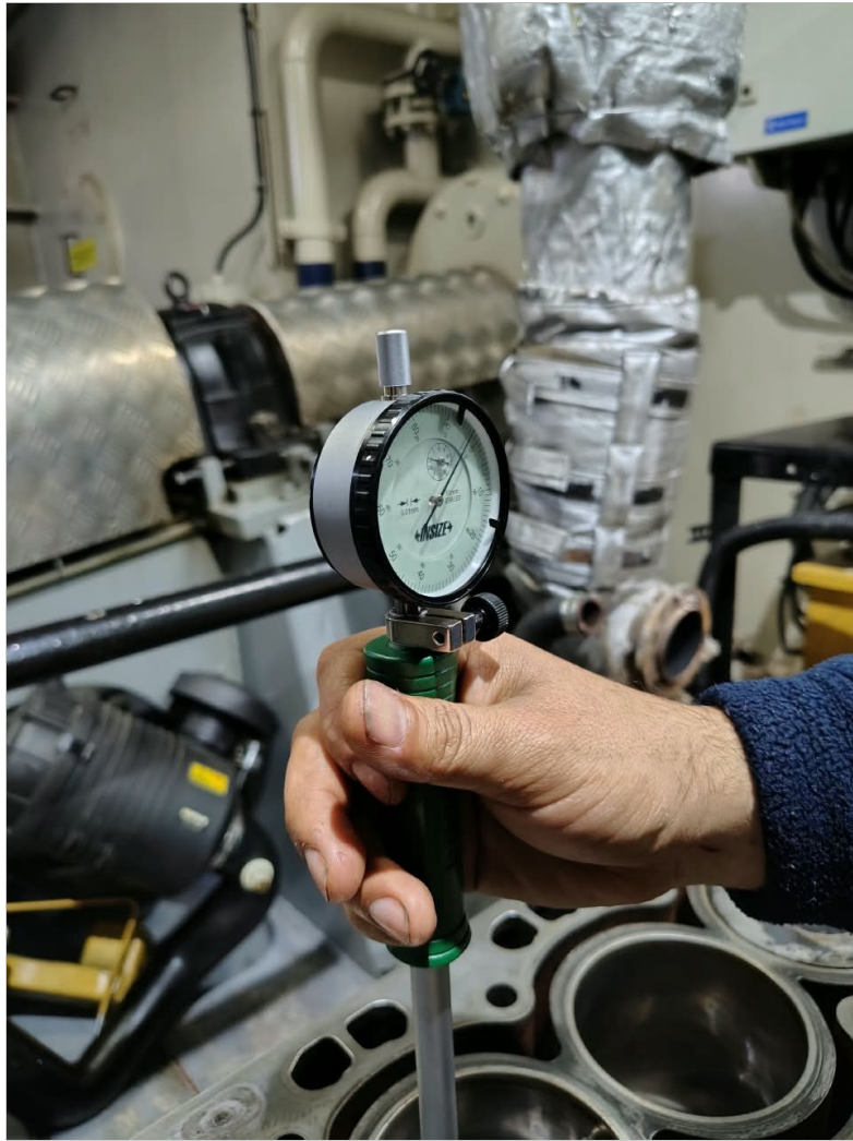
Control de cubicidad de cilindros
