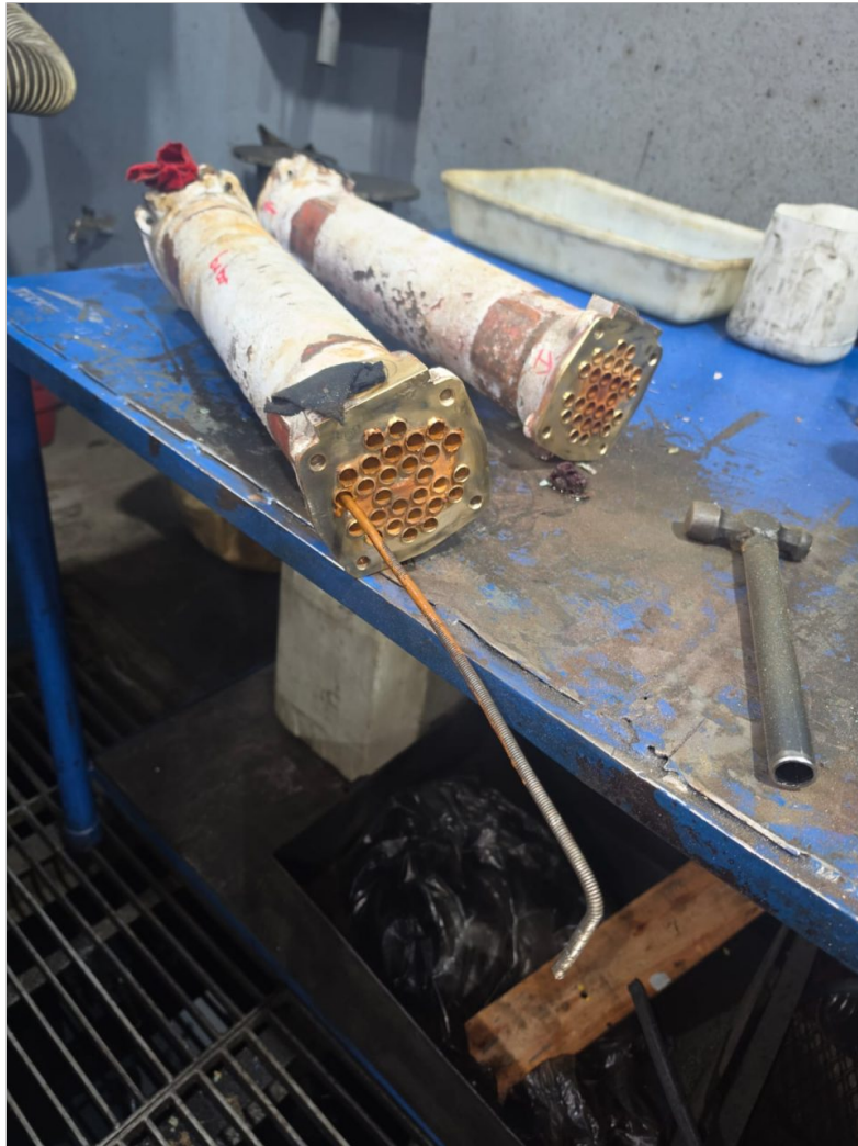
Recorrido de enfriadores de aceite de transmision en taller
