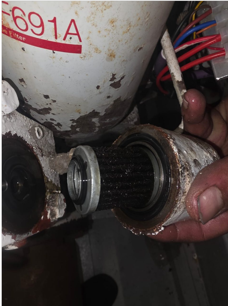
Estraccion para lavado de filtro magnetico de aceite de transmision
