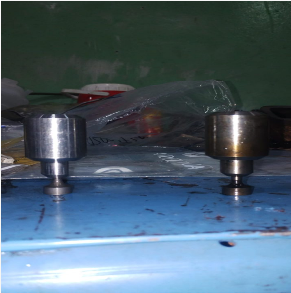
piston nuevo (derecha) bomba transferencia gasoil
