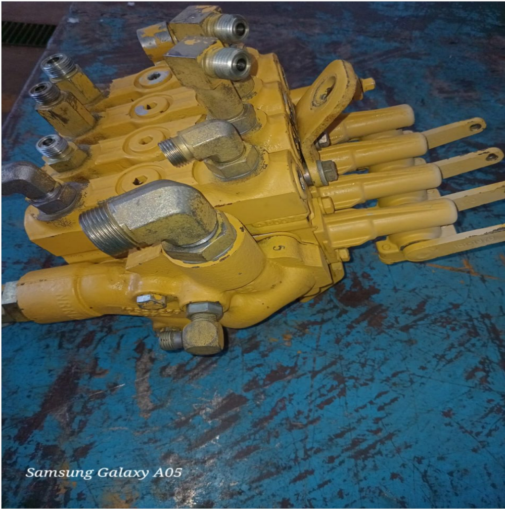
banco derecho de implementos reparado
