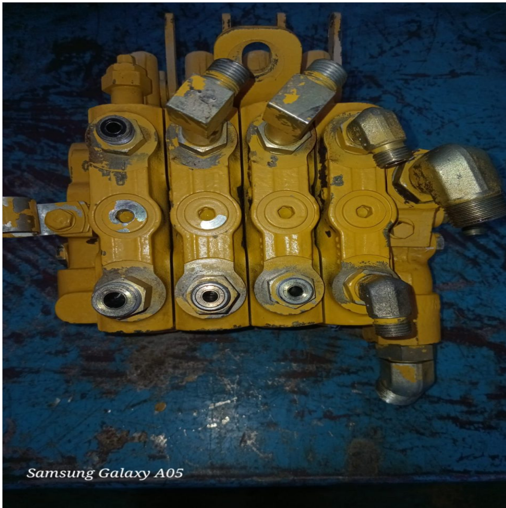
banco izquierdo de implementos reparado
