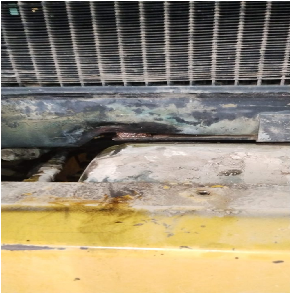
radiador deteriorado con perdida
