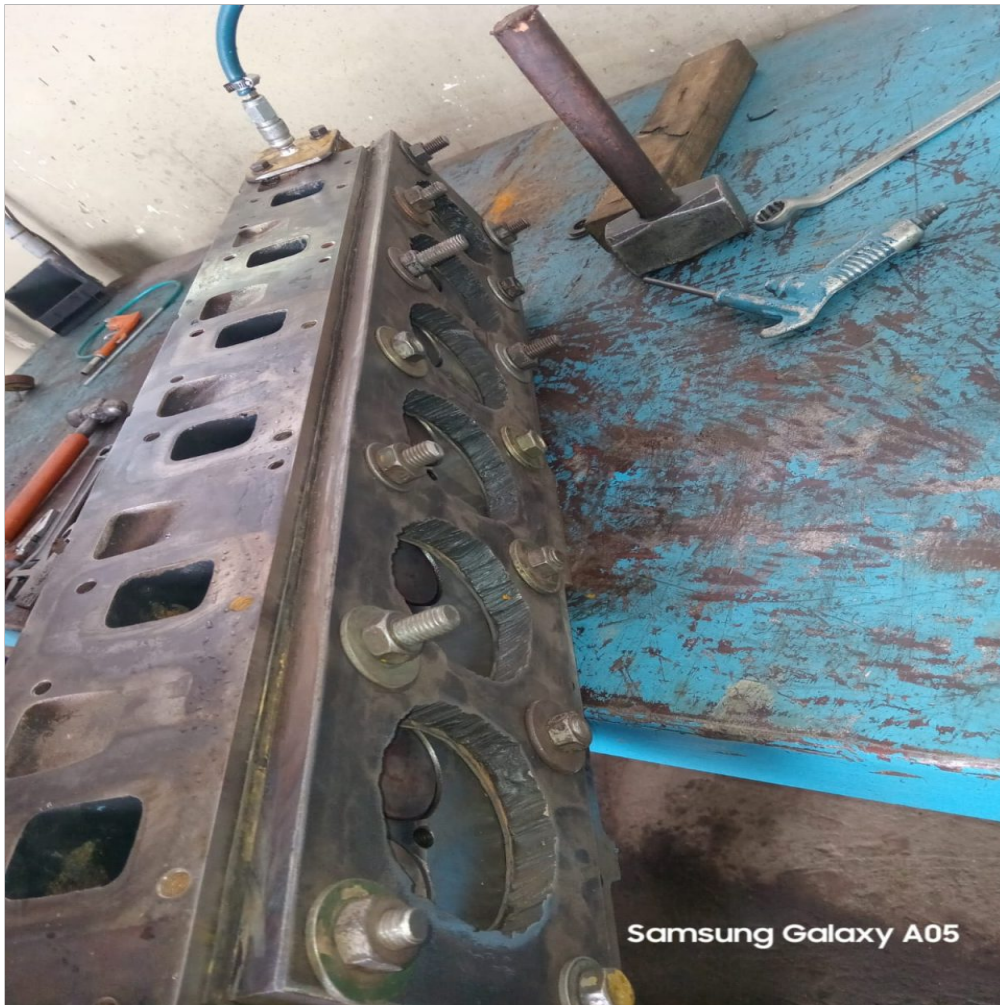
prueba hidráulica tapa cilindro
