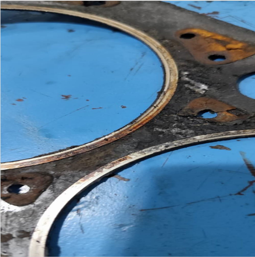
junta tapa cilindro deteriorada
