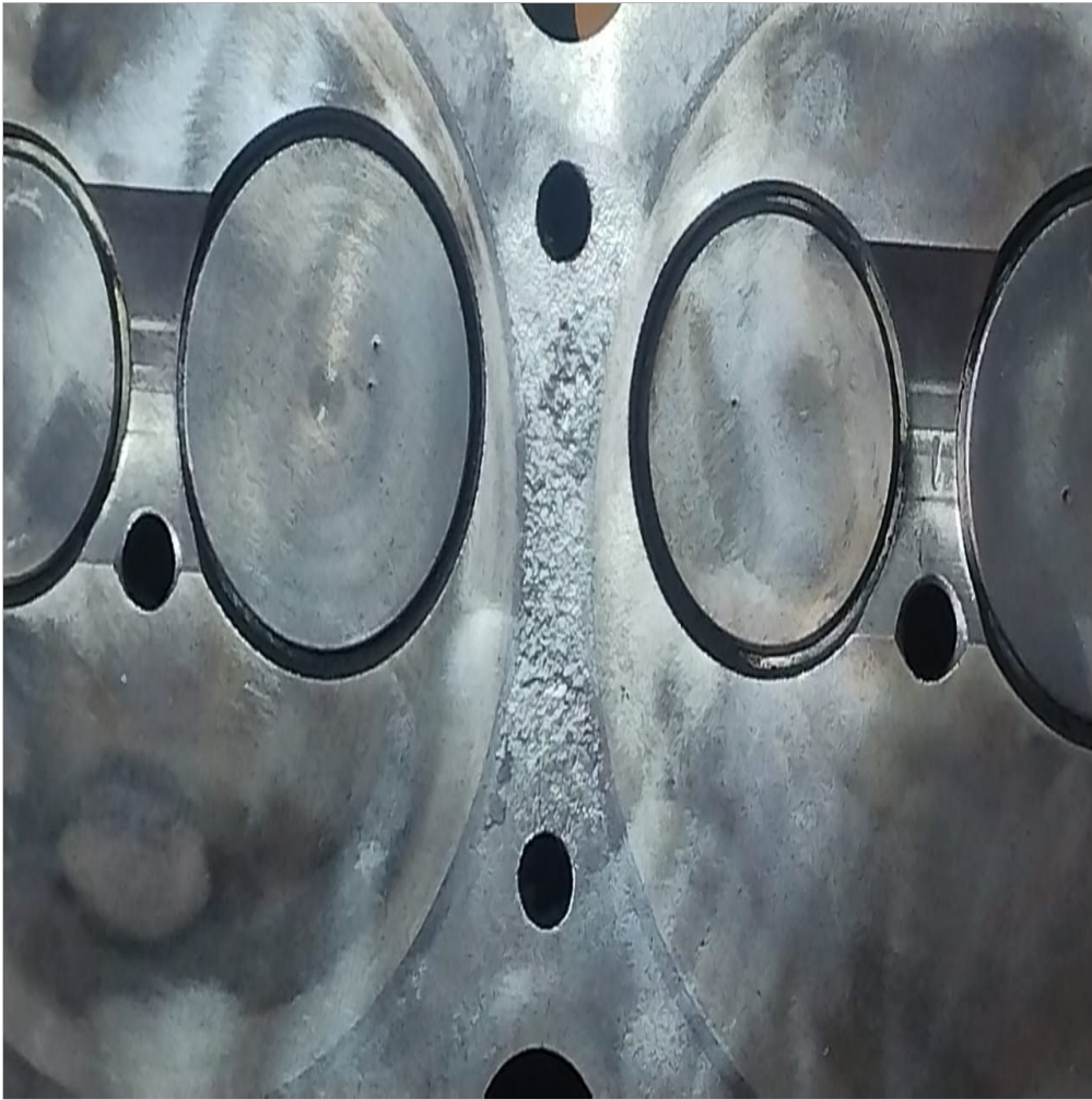
plano superior de tapa de cilindro picado
