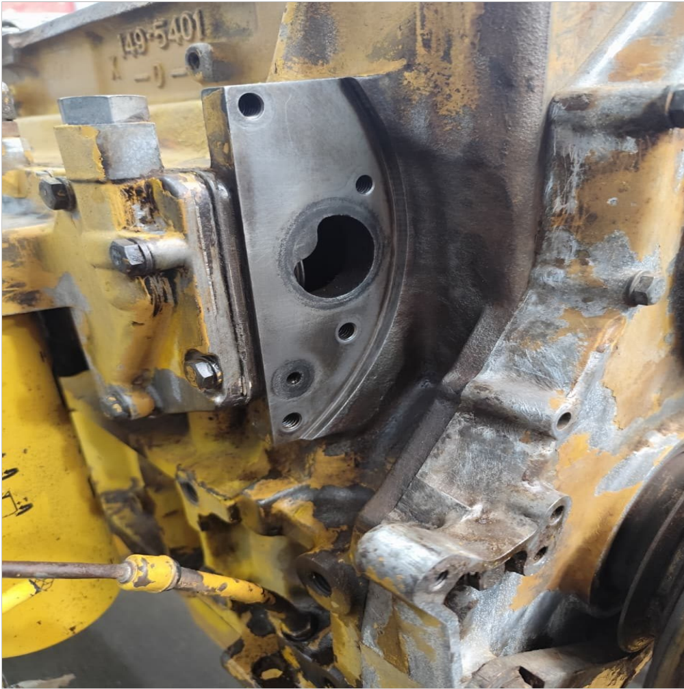
reparación en alojamiento bomba de agua
