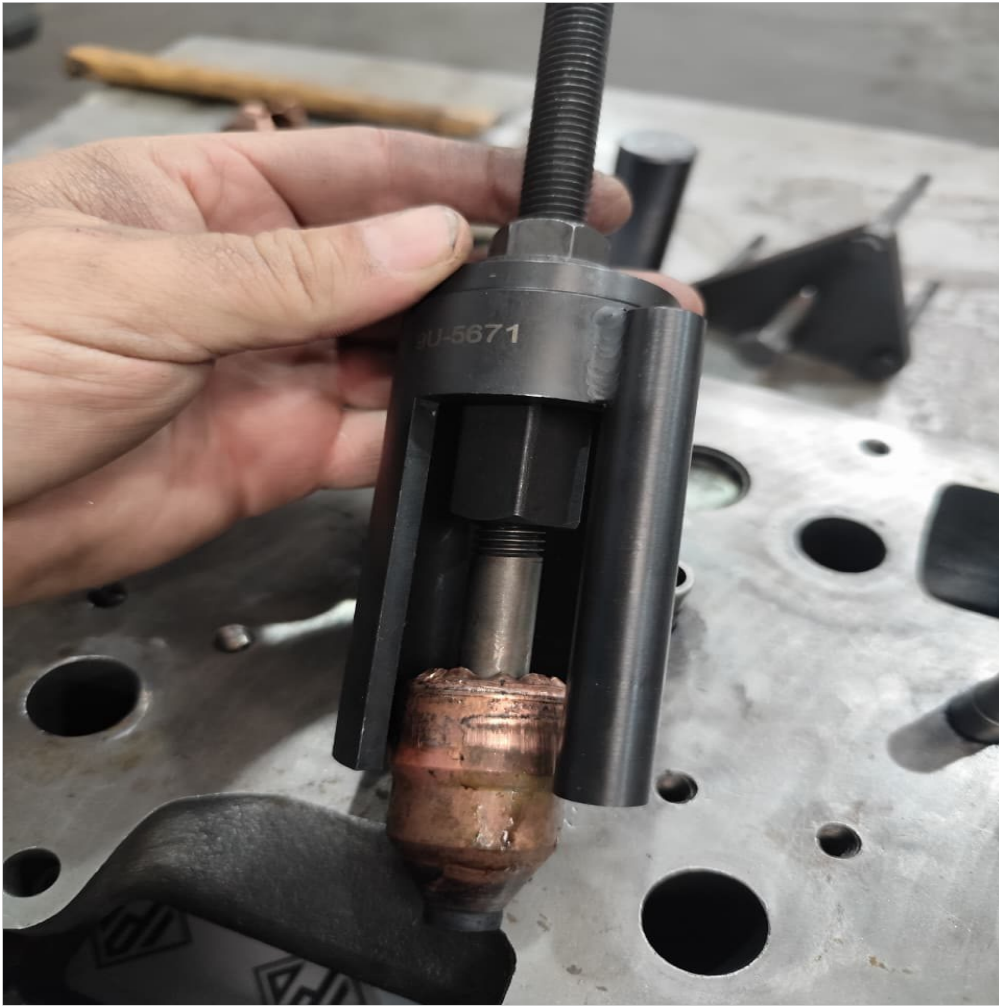
extracción de camisas de inyección
