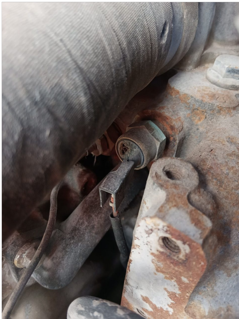
sensor temperatura dañado
