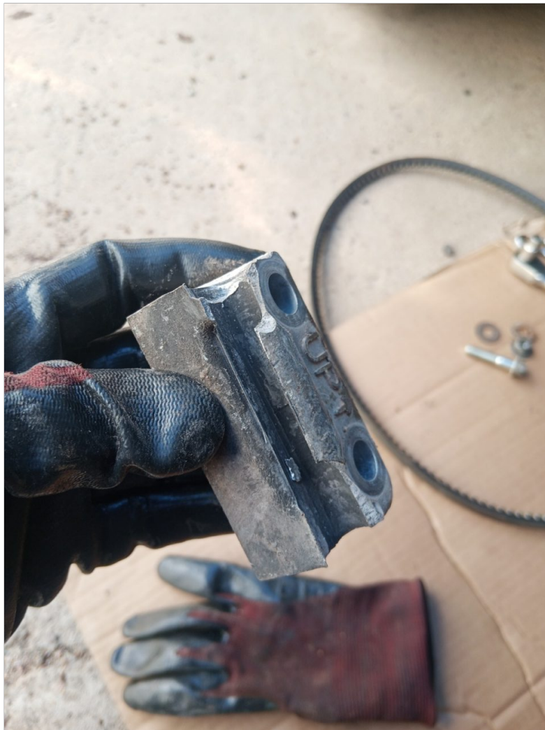
soporte alternador dañado
