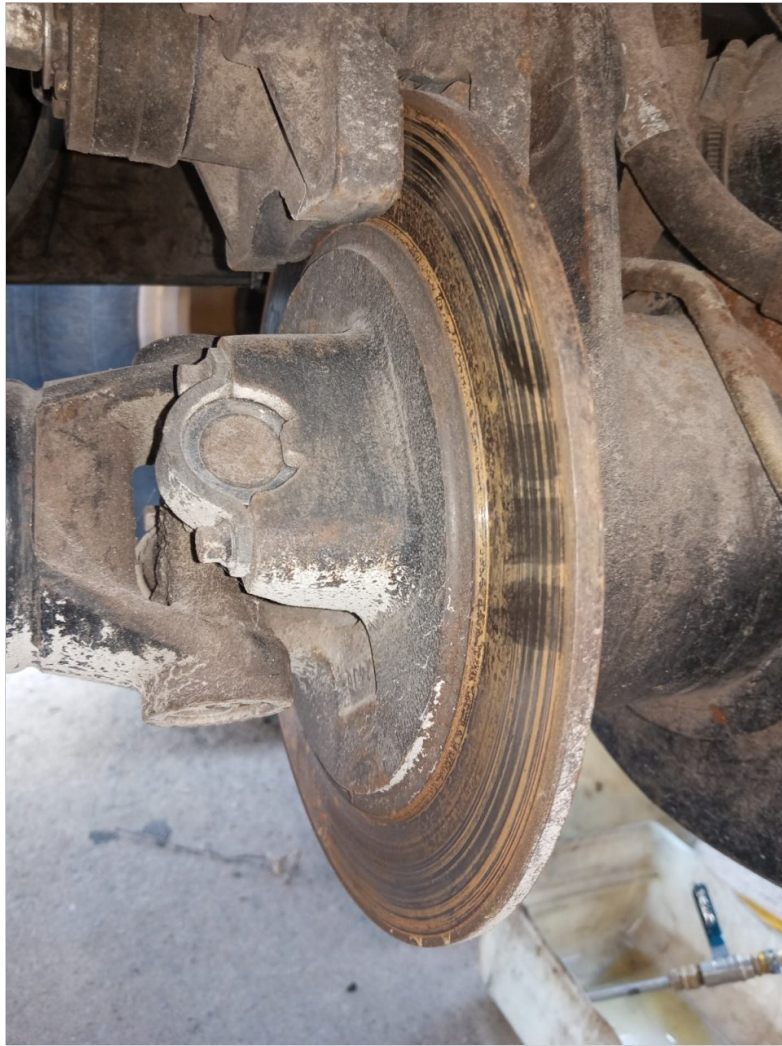
disco freno estacionamiento dañado
