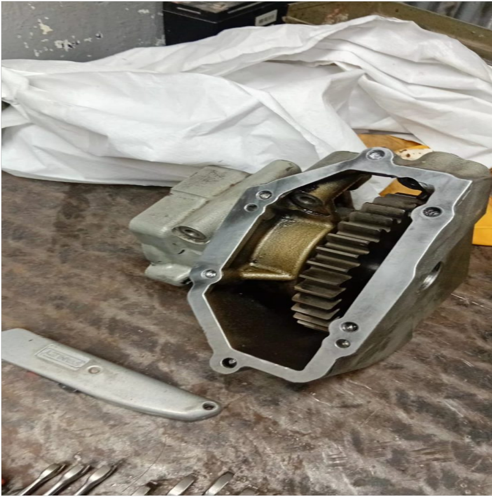
mando de bomba de agua mar
