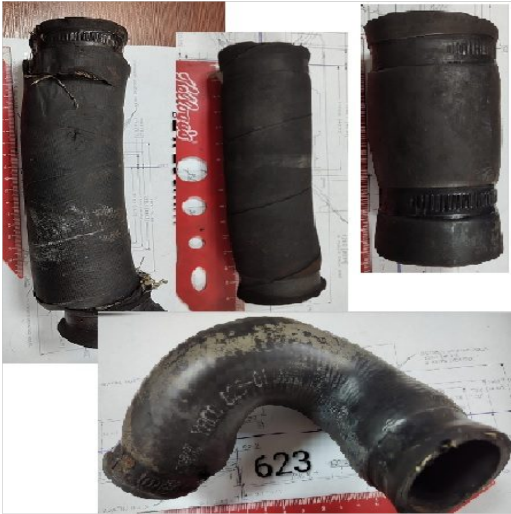
Mangueras en mal estado
