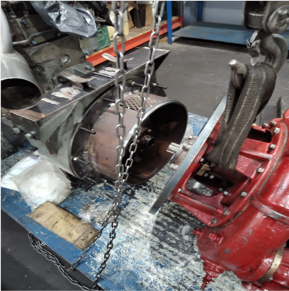
Se fabrica un acople para unir la bomba al motor
