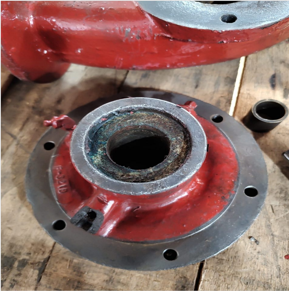
Se reparo conexión partida
