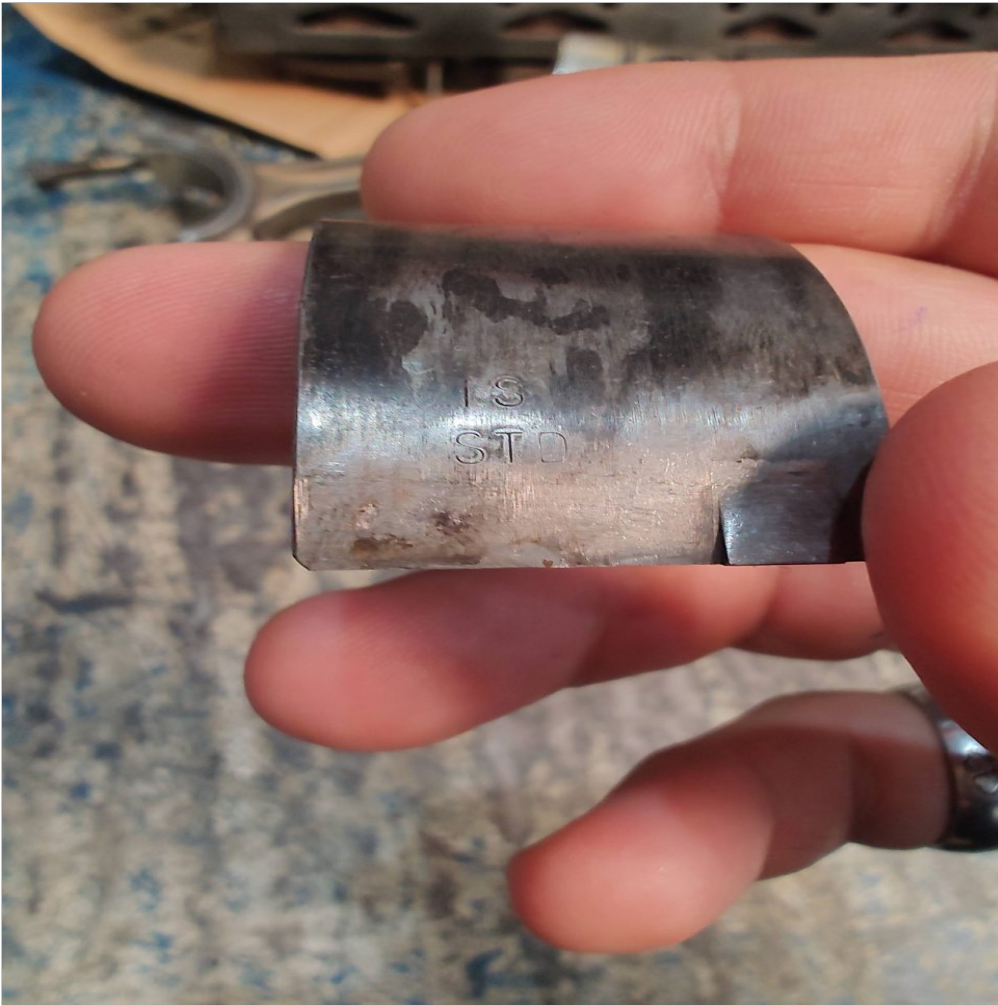
Metales en mal estado, se reemplazaron por nuevos en medida estándar
