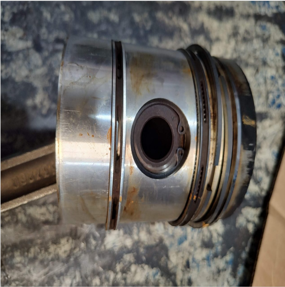
Pistones y aros en mal estado reemplazados
