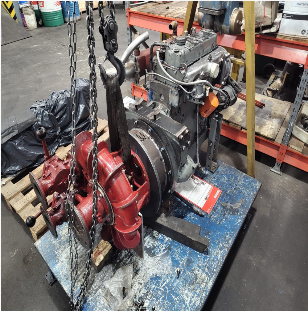
Bomba anti incendio acoplado al motor
