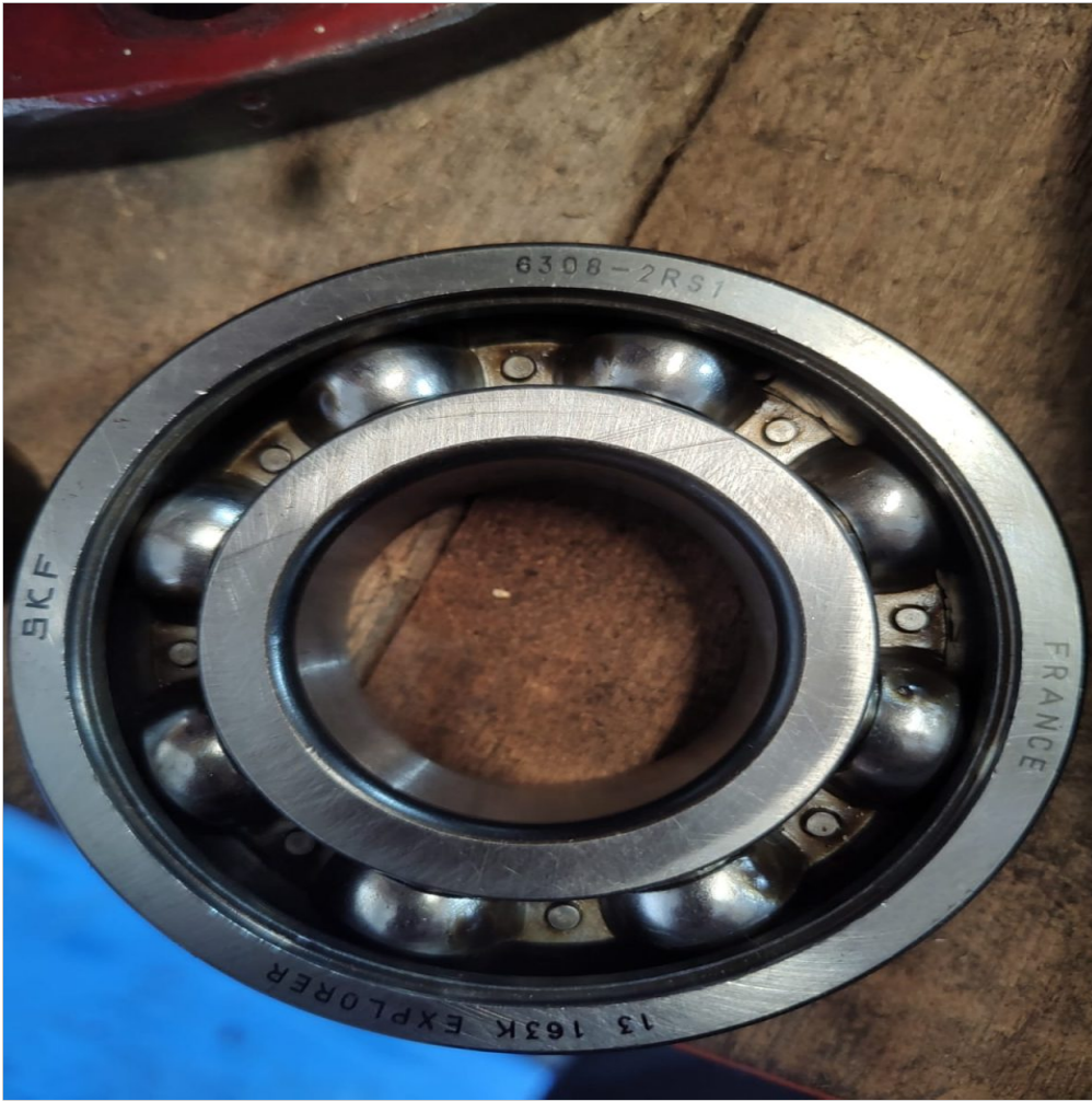
Rodamiento en mal estado
