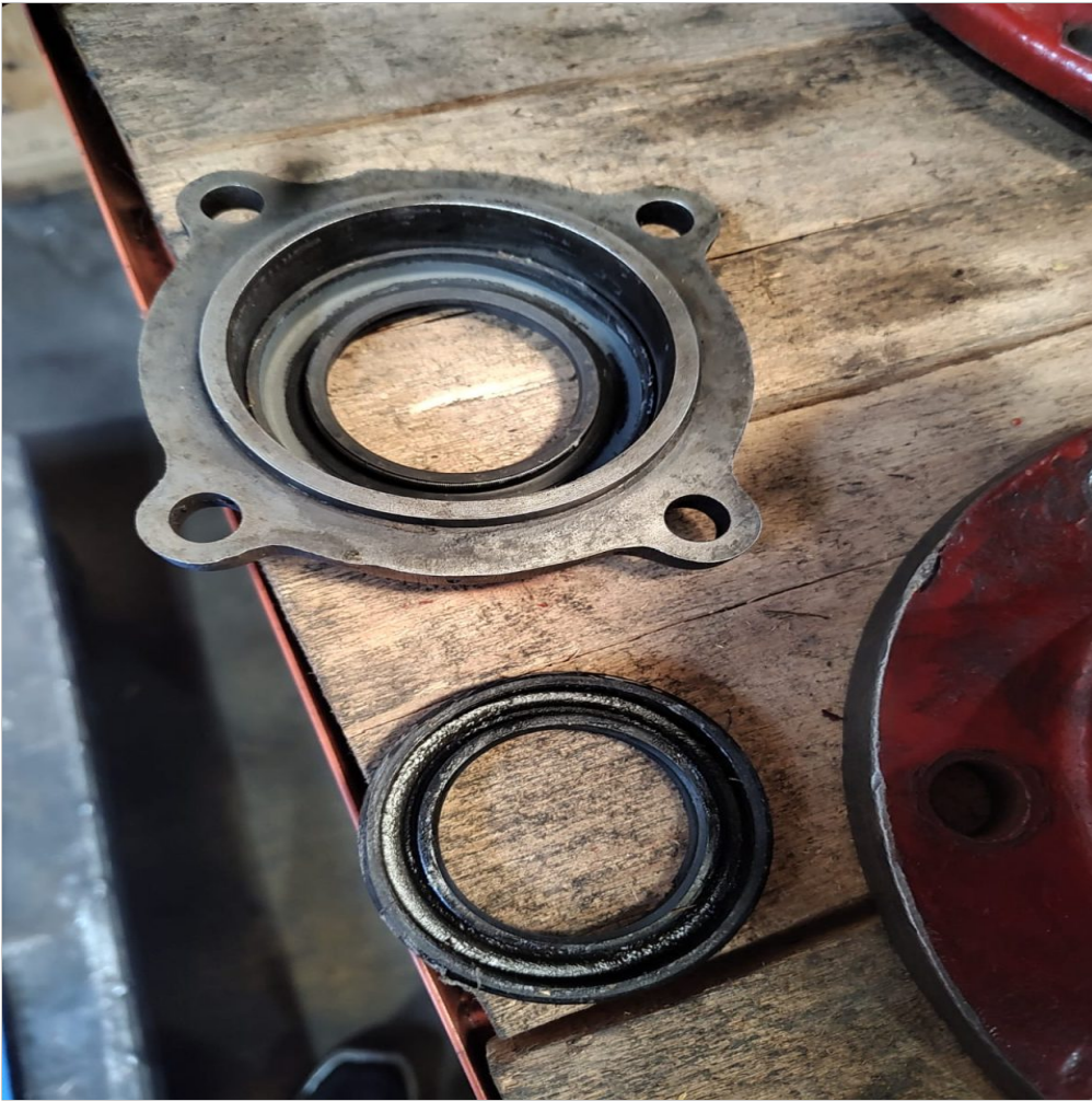
Sellos desgastados y rotos
