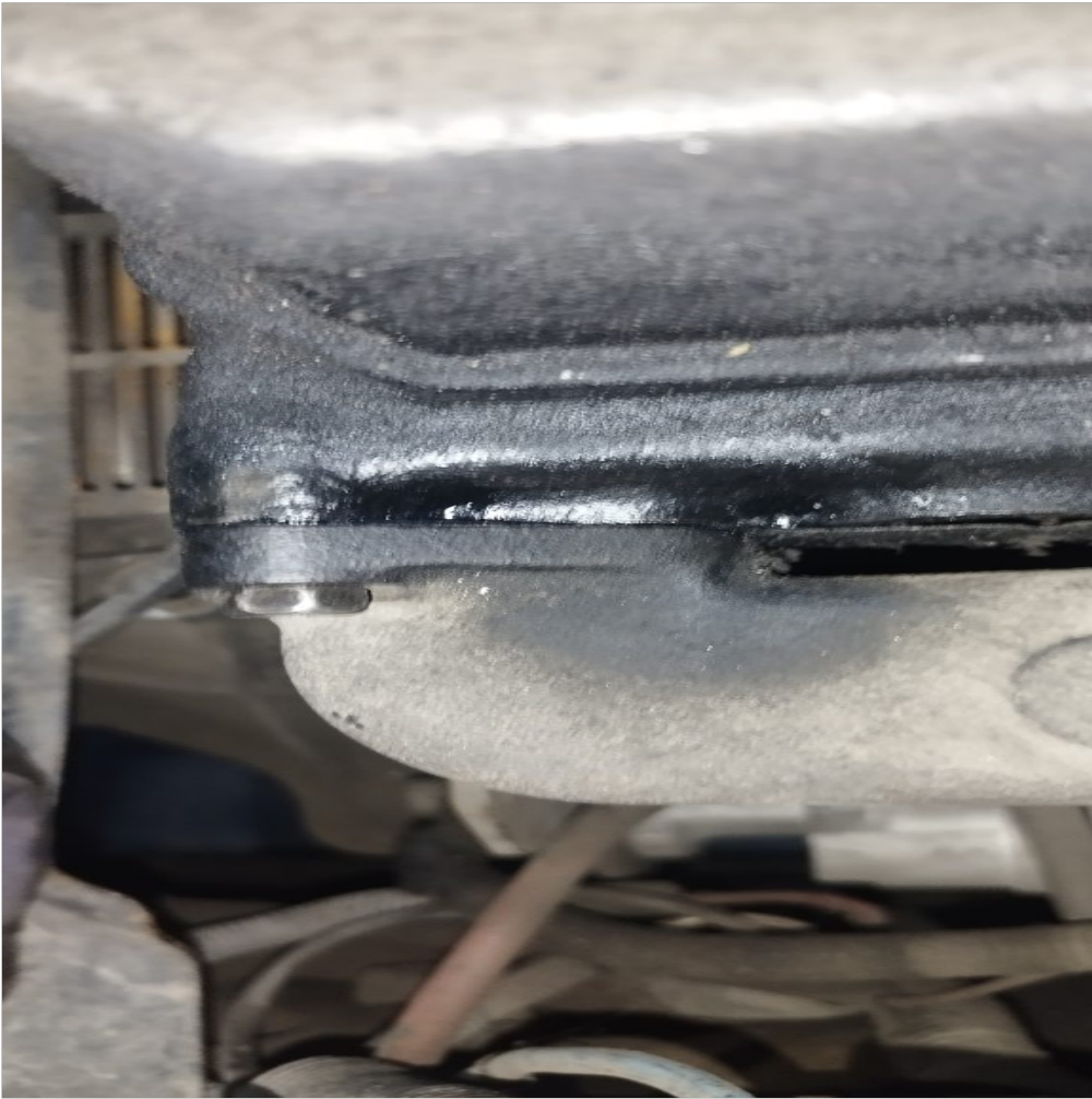
Fuga de escape por múltiple de escape
